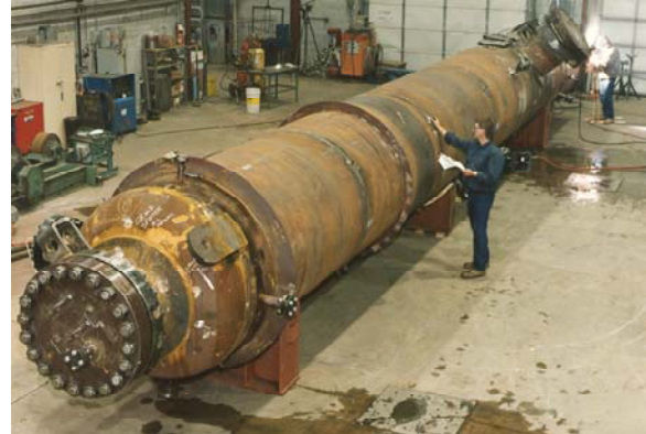
Fig. 10 Réacteur en acier au carbone de catégorie 1, de 1/8 pouce (SA-516-70) avec gaine de titane, pour la production de produits chimiques organiques.
