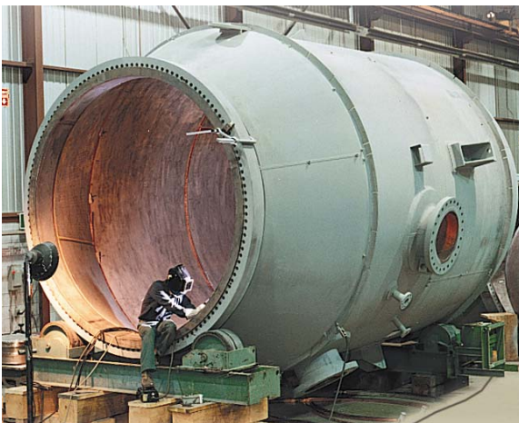
Fig. 9 Partie d'un réacteur construite en acier au carbone SA-516-70 avec gaine de titane.
