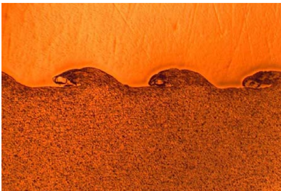
Fig. 4 Soudage par explosion de titane sur de l'acier au carbone (Photo : Produit de placage)
