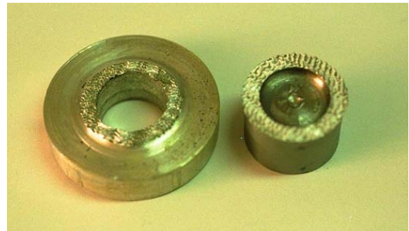
Fig. 7 Spécimen de test de tension d'un éperon de gaine (Photo : Produit de placage)
