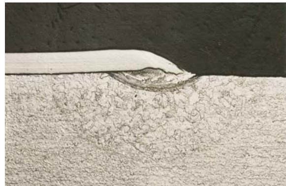
Fig. 1 Du tantale (0,5mm, 0,020 po) soudé à du titane.
